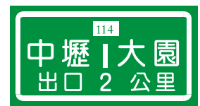
高速公路出口預告 (設於交流道出口前 2公里處)
